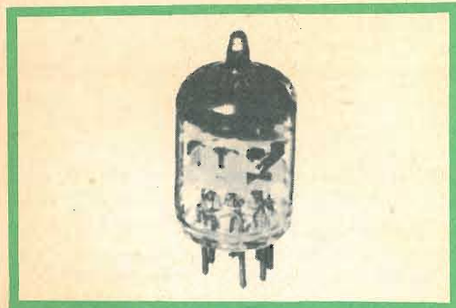
Fig. 2 - Il triodo VHF PC 900. Scala 1 : 1
