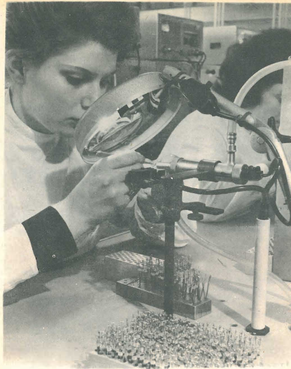
Fig. 9 - Aggraffatura dei transistor per bassa frequenza Philips.
